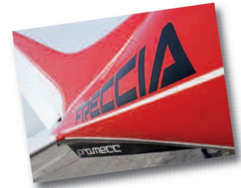
Pour gagner en masse, la partie inférieure du fuselage est laissée "brute", avec un simple vernis de protection pour protéger la fibre de carbone.
