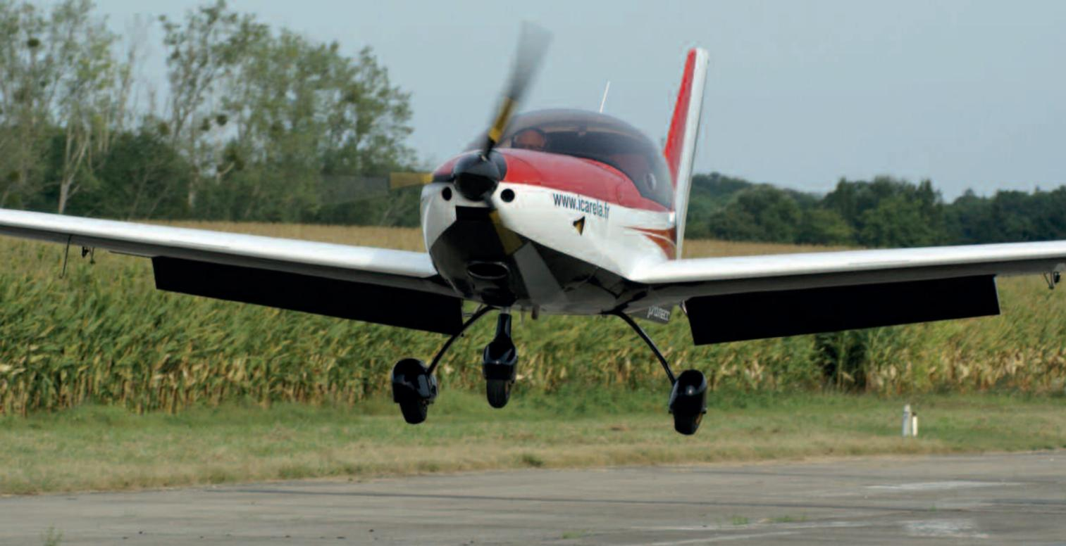
Que ce soit à la sortie ou à la rentrée des volets, voire lors d'une remise de gaz, les réactions du Freccia sur l'axe de tangage sont plutôt placides n'imposant pas une recompensation à chaque fois.
